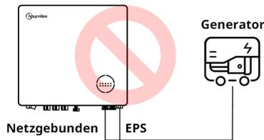
Weder der EPS- noch der netzgebundene Anschluss können direkt am Generator angeschlossen werden.
